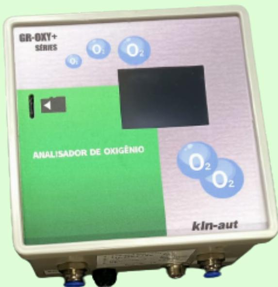
A velocidade de propagação de um sinal de ultrassom transmitido dentro do sensor repleto de gás varia de acordo com a concentração de oxigênio e de outros gases, por isso, um trem de pulsos é transmitido pelo oscilador para um receptor que filtra e condiciona esse sinal para fornecer uma saída com valor linear correspondente a concentração de oxigênio.
